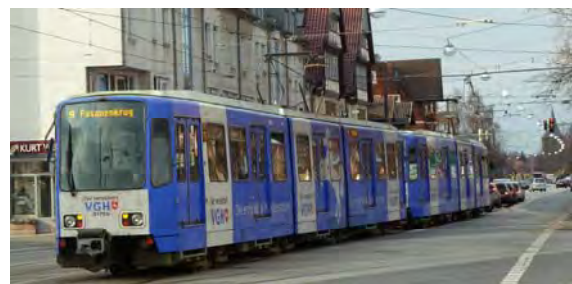
Abbildung 2: Stadtbahnstrecke, straßenbündiger Bahnkörper
