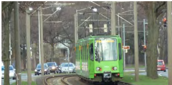
Abbildung 1: Stadtbahnstrecke, besonderer Bahnkörper
